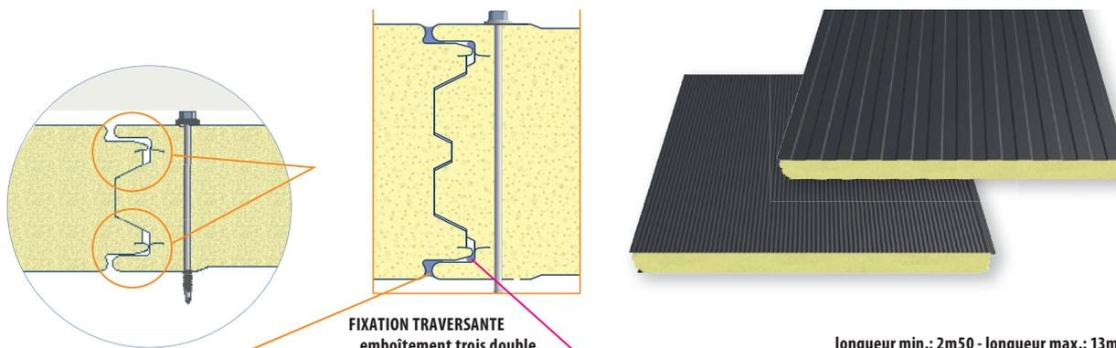
Montage de damp-proof sur le chantier peut être obtenue en plaçant le **butyl** de chaque côté et de remplir le forme **diabolo** sur les deux côtés avec un kit.
